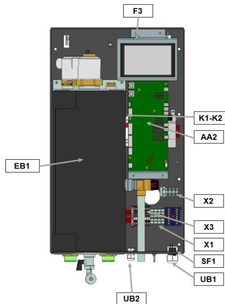
Při kladení kabelů v zařízení **HM09A** použijte kabelové průchody UB1 a UB2 (označené v nákresu). V UB1 a UB2 jsou kabely vedeny v celém vnitřním modulu od **zadní stěny směrem k přední stěně**.
