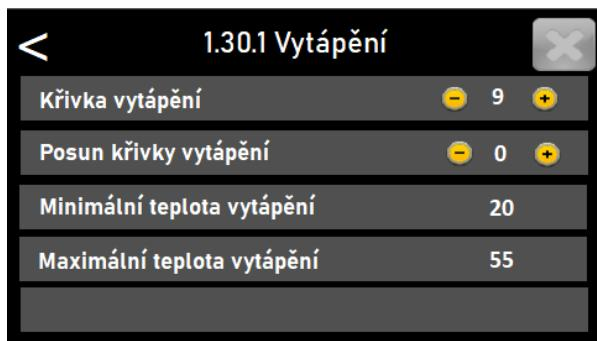
Přípustné minimální a maximální teploty v řídicím systému představují omezení, která nejsou v grafech uvedeny. Minimální teplota na výstupu vytápění má tovární nastavení 20°C. Maximální vypočitatelná teplota z topné křivky má tovární nastavení 55°C. Tovární nastavení křivka č.9 (posun 0).
